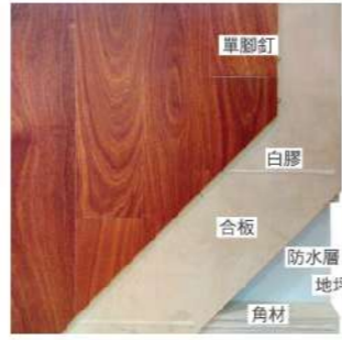
架高式施工法
